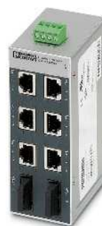
6 портов RJ45 и 2 оптических порта
