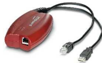
Маршрутизатор с межсетевым экраном для мобильного применения
