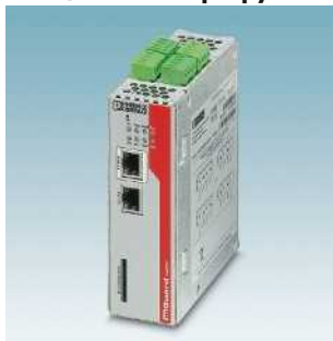
Межсетевой экран mGuard для установки на DIN-рейку
