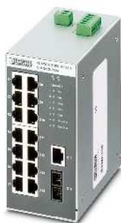
15 портов RJ45 и 1 оптический порт
