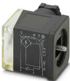
Защитная схема: варистор и выпрямитель
