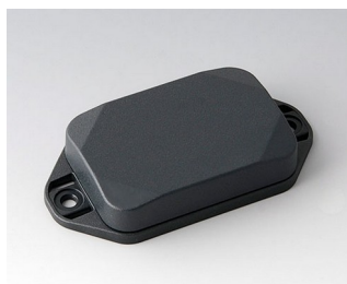
B1822128 MINI-DATA-BOX EF40, плоский, с ушками АСА+ПК (UL 94 V-0) тёмно-серый RAL 7016 60x40x15mm IP 65 opt., IP 40
