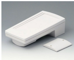
A9046107 HAND-TERMINAL M, исп. I ПК+АБС (UL 94 V-0) белый RAL 9002 220x120x65mm IP 65 opt.
