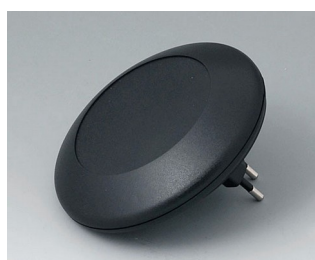
B5011229 ART-CASE R110 F (с вилкой) ПК+АБС (UL 94 V-0) черный RAL 9005 ø110x38mm IP 40
